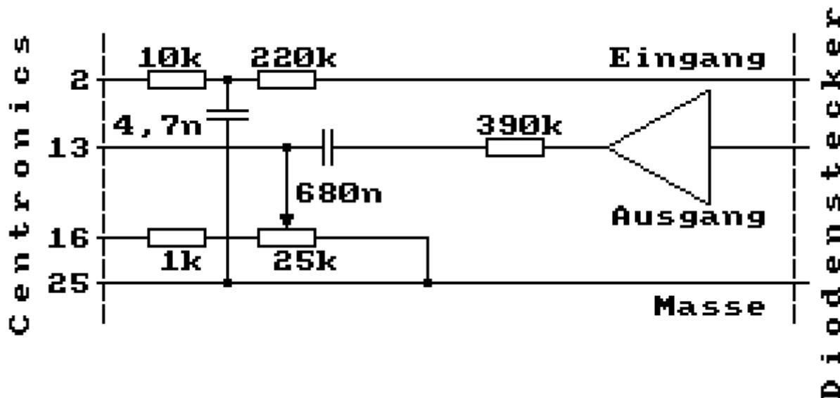
Die Aufzeichnung erfolgt mit einer 1200-Hz-Schwingung für ein 0-Bit und zwei 2400-Hz-Schwingungen für ein 1-Bit.
